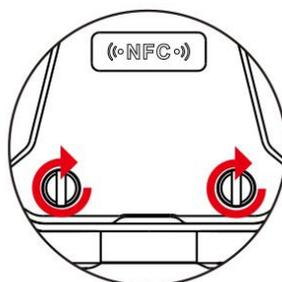
Vérifiez que la bague d'étanchéité intérieure est en bon état, puis installez le couvercle de la batterie et serrez les deux vis dans le sens des aiguilles d'une montre.
