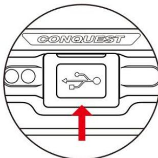
Le port USB doit être fermé hermétiquement
